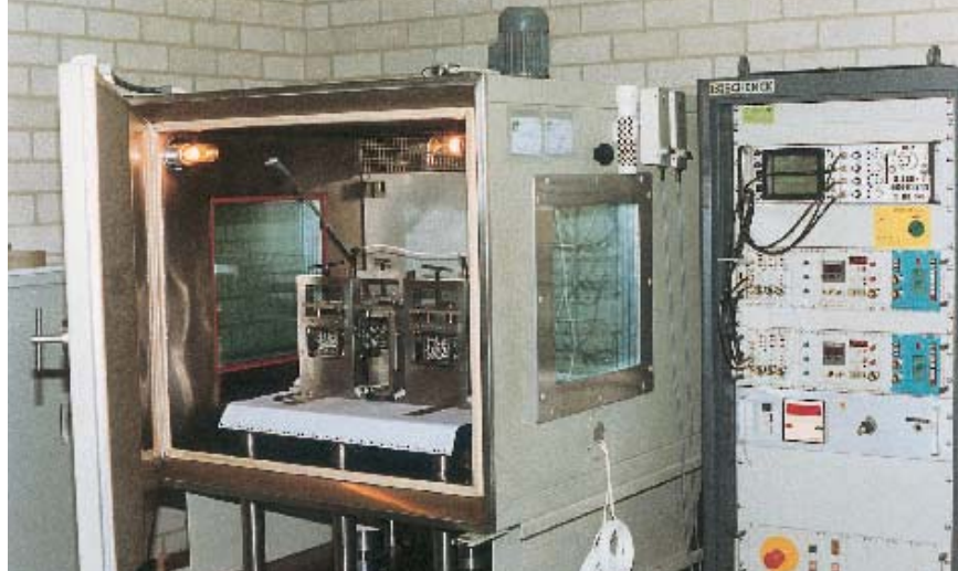
Figuur 2.9 Testbank met klimaatkast voor het uitvoeren van dynamische proeven (Foto: NPC)
