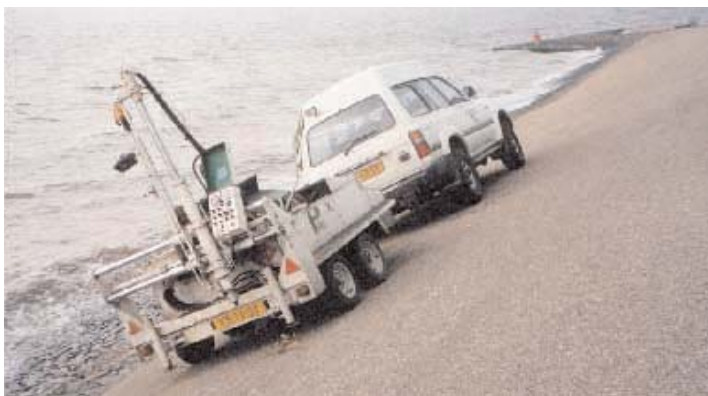
Figuur 9.3 Voor een gedetailleerde beoordeling worden kernen uit een bekleding geboord (Foto: NPC)
