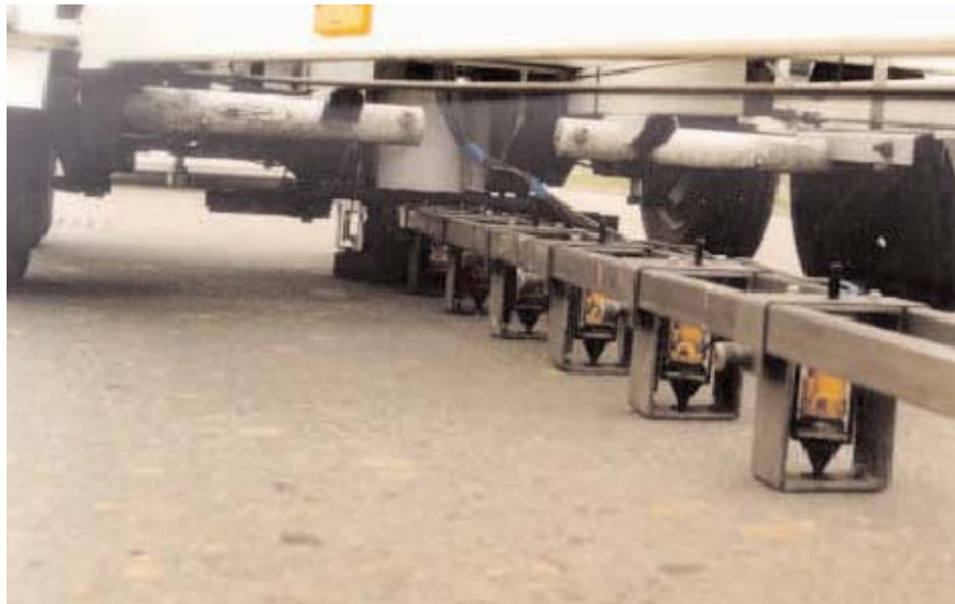
Figuur 9.11 Valgewicht-deflectiemeter: meetbalk met geofoons (Foto: NPC)
