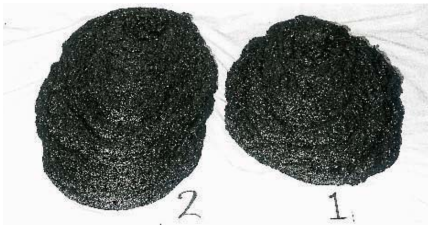
Figuur 2.14 Plak uitgevloeide asfaltmastiek
