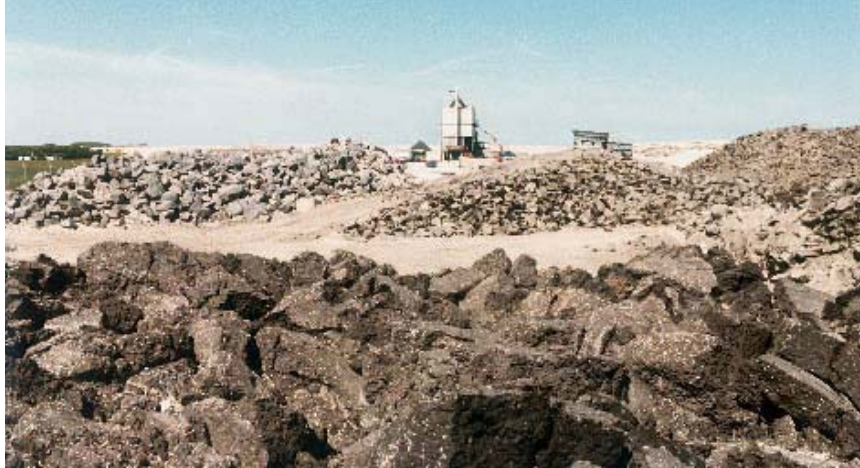
Figuur 8.32 Depot asfaltshollen voor hergebruik in bekleding van waterbouwasfaltbeton - Onrustpolder - 1985
