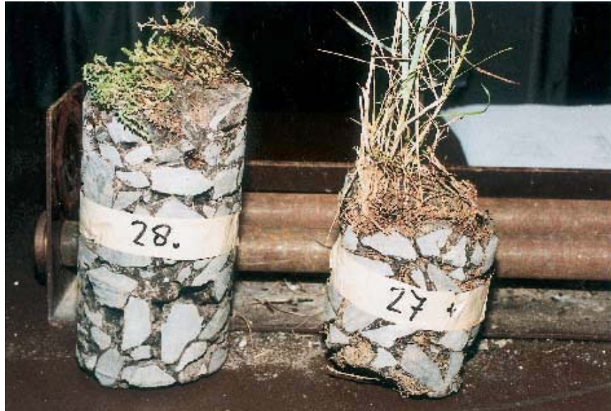
Figuur 2.17 Boorkernen uit een begroeide bekleding van open steenasfalt - Tholen - 1995 (Foto: Oranjewoud)
