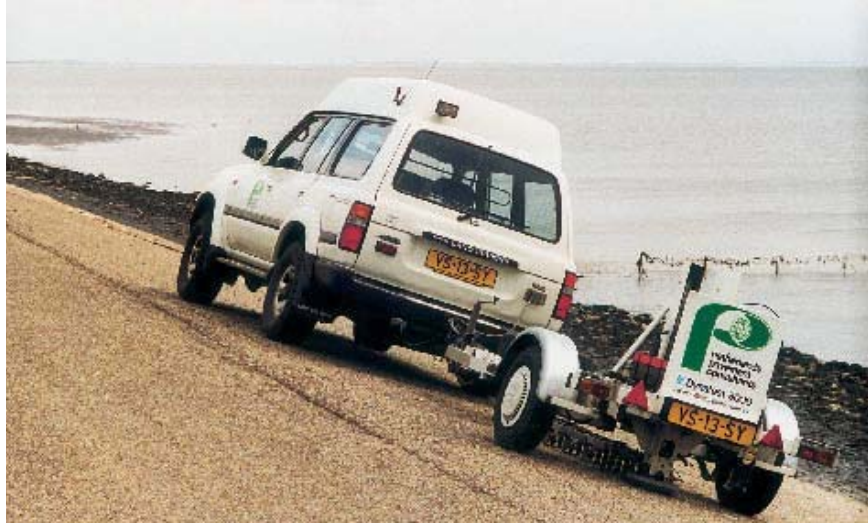
Figuur 9.10 Valgewicht-deflectiemeter op een dijktafud (Foto: NPC)
