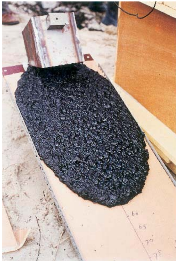
Figuur 2.11 Hellingproef voor het bepalen van de viscositeit
