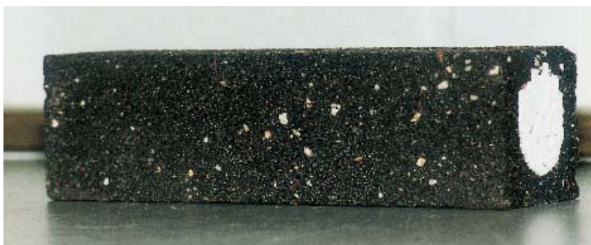
Figuur 2.18 Balkje uit een bekleding van zandasfalt - 1998 (Foto: NPC)
