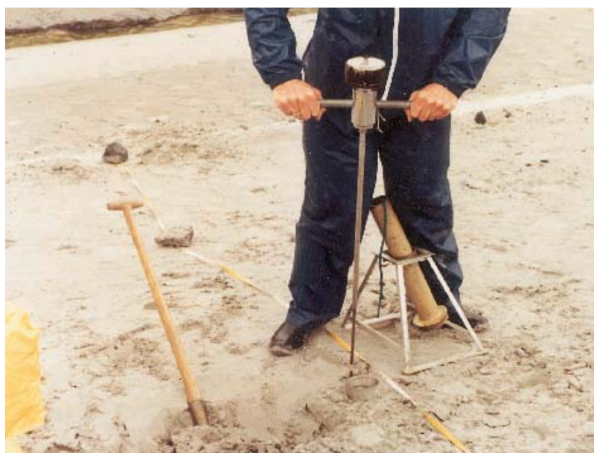
Figuur 8.3 Dichtheidscontrole van het zandbed met handsondeerapparaat en steekring - Sjoukeshoek - 1983
