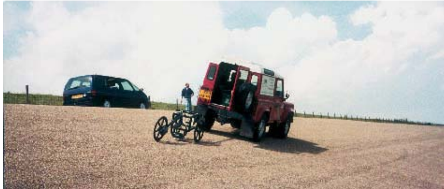
Figuur 9.8 Radarmetingen op de asfaltbetonbekleding van Texel - 1999 (Foto: NPC)
