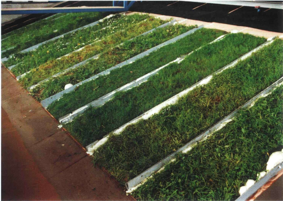
figuur 3.4: Grootchalige proeven met rivierdijkgraszoden. (Bron: Waterloopkundig Laboratorium)
