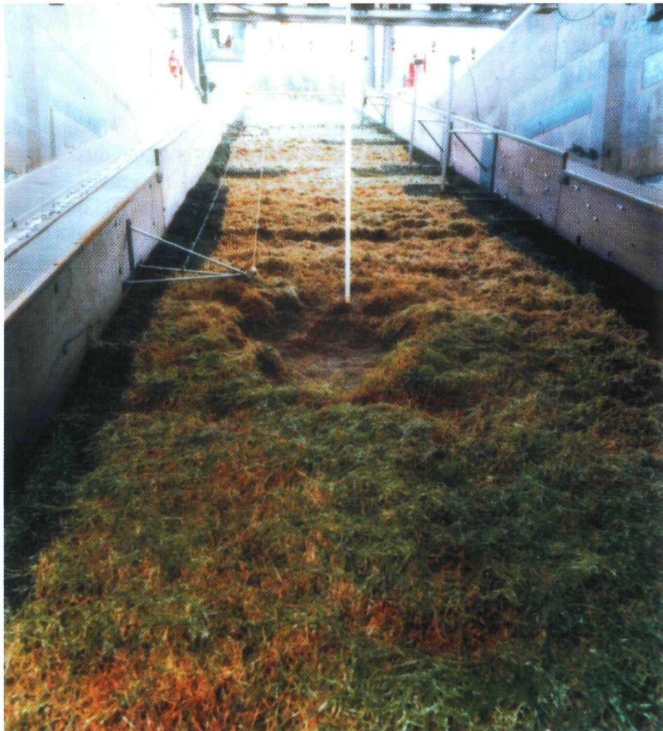
figuur 3.5: Gat na 11 uur golven bij een grootschalige proef met zeedijkgraszode. (Bron: Waterloopkundig Laboratorium)
