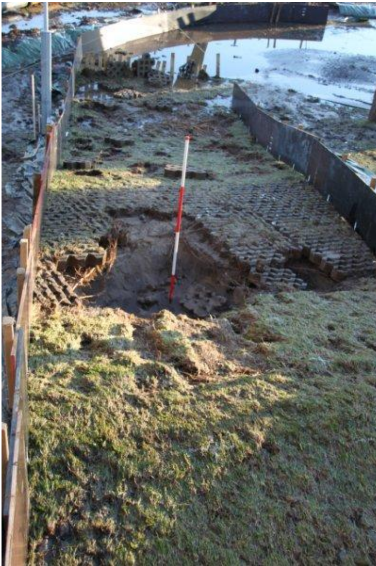
Foto B41. Vechtdijk. Zeeregime met dijkovergang, proef 1; Proef gestopt, overgang bezweken.
