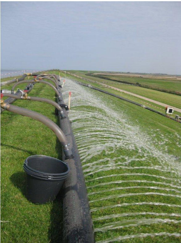
Figuur 4.8 Wateraanbod bij infiltratie en afschuifproef (Friese Waddenzeedijk nabij de Boonweg)
