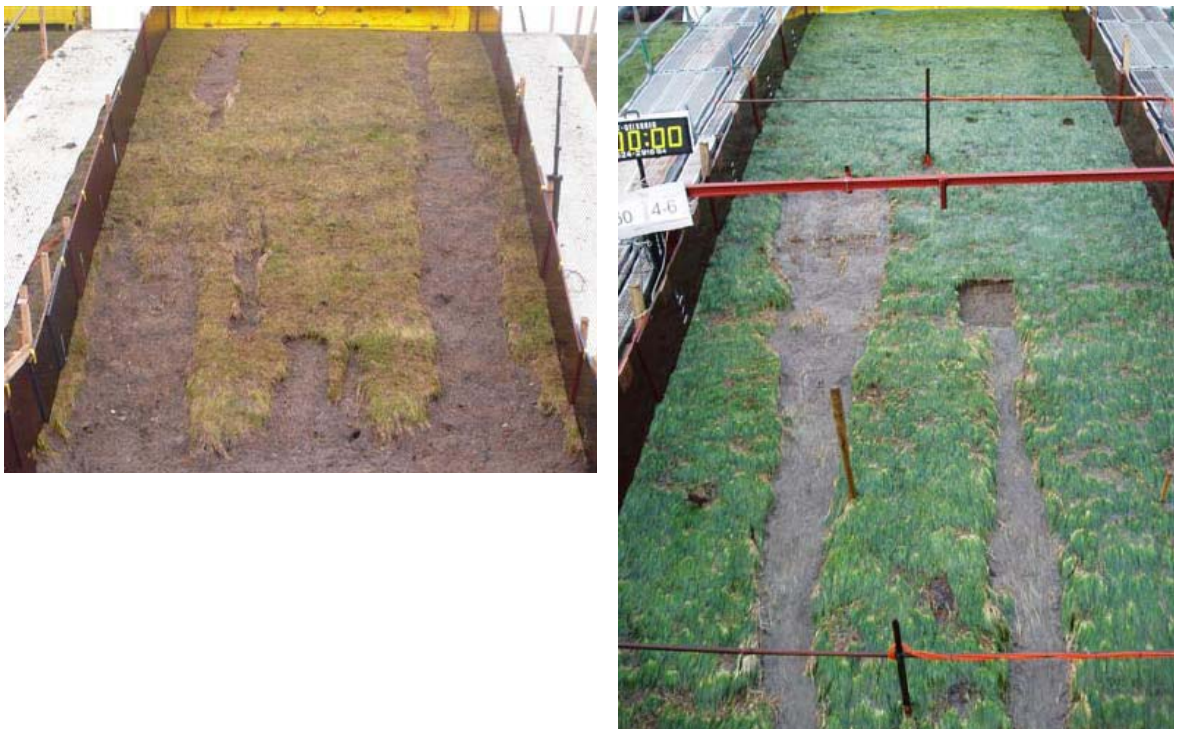
Figuur 5.5 Afstropen van een deel van de toplaag (Afsluitdijk) en afstropen na aanbrengen van schades (Zeedijk bij Delfzijl)
