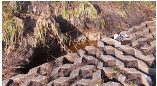
Figuur 8.5 Schade aan teen na 30 l/s per m (Golfoverslagproeven Boonweg, Fryslân)
