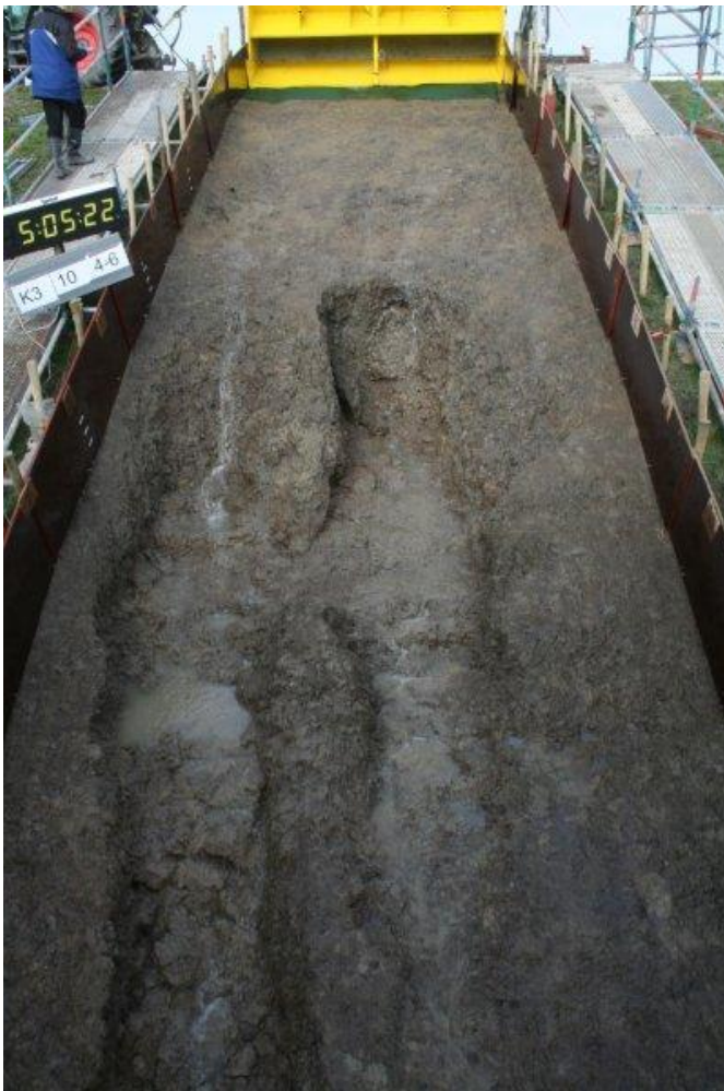
Foto B4. Delfzijl. Kale klei. Vrijwel aan het eind van de proef; 5-10 cm oppervlakte erosie.
