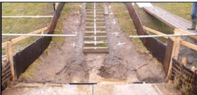
Figuur 8.2 Schade als gevolg van stroomconcentratie na zeer grote overslagdebieten (Golfoverslagproeven Afsluitdijk, 6 uur 50 l/s per m)
