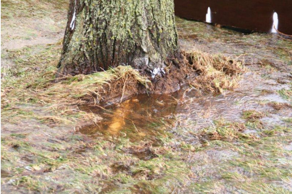
Foto B46. Vechtdijk. Zeeregime met boom, proef 2; Eerste boomwortel geërodeerd.
