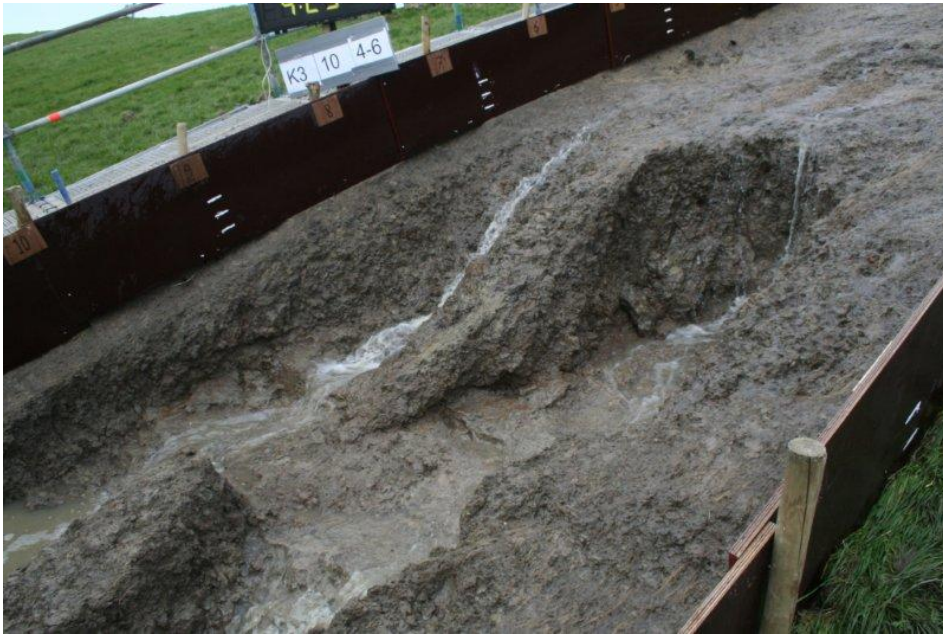
Foto B3. Delfzijl. Kale klei. Ontwikkeling van head cut erosie bij het rechtse gat.
