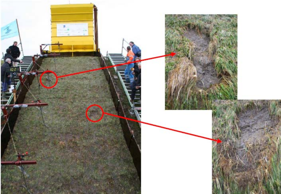
Figuur 5.1 Uittrekmechanisme (golfoverslagproeven op St. Philipsland)
