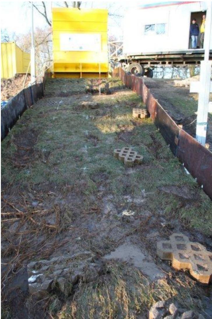
Foto B39. Vechtdijk. Zeeregime met dijkovergang, proef 1; Talud na de proef niet bezwaken.
