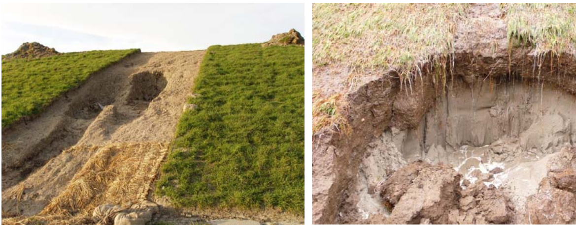
Figuur 5.6 Head cut erosie op een zeedijk van kale klei bij Delfzijl, beproefd met de golfverslagsimulator na verwijderen van de toplaag (links). Head cut erosie bij zanddijk met kleibekleding Sint Philipsland (rechts)
