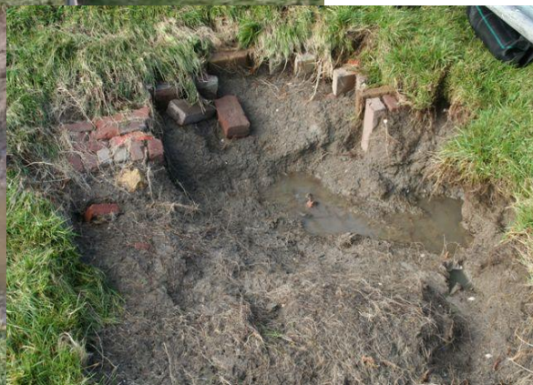
Foto B11. Boonweg. Sectie 3. Na de proef, schade aan het talud en aan de teen.
