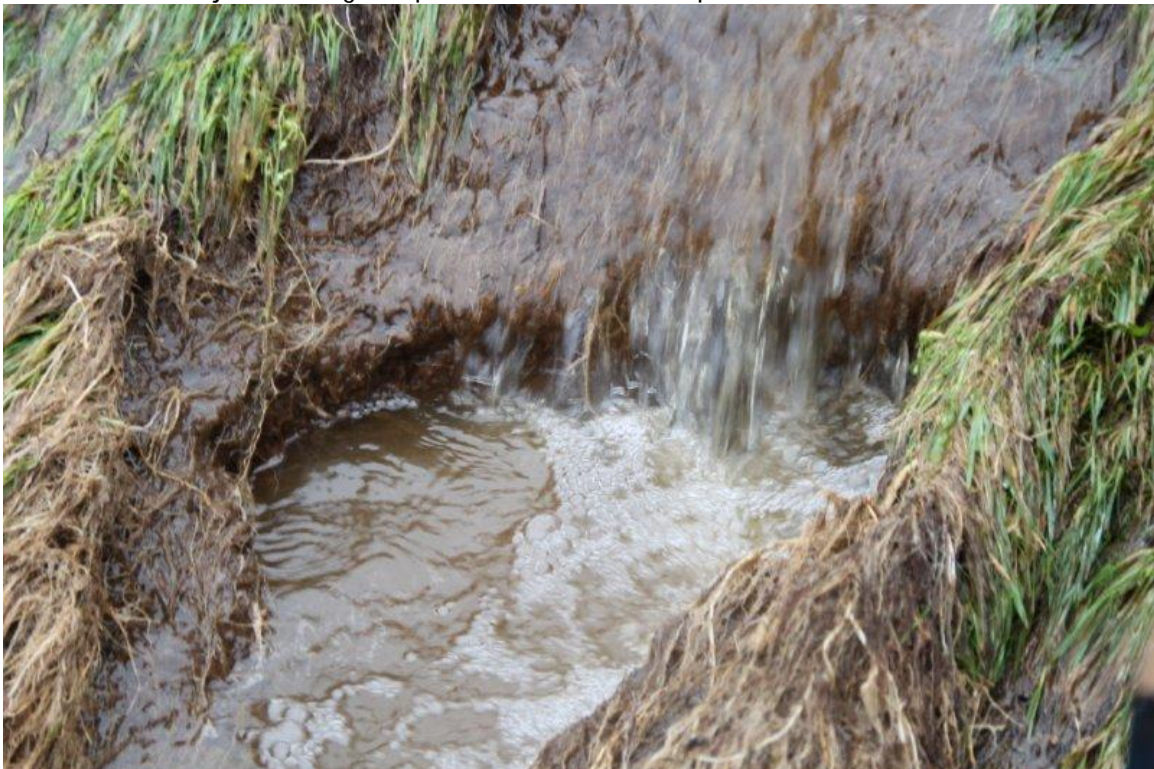
Foto B59. Vechtdijk. Rivierregime, proef 4; Zand komt vrij door afdeklaag.
