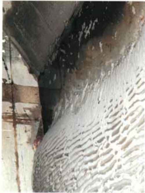
Fig. 6.4 Ontgrondingskuil voor een duinvoetverdediging na het optreden van een stormvloed (modelonderzoek Waterloopkundig Laboratorium).
