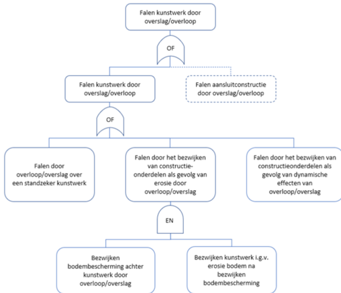
Figuur 1 Gangbare modellering van het faalmechanisme overslag en/of overloop bij kunstwerk.
