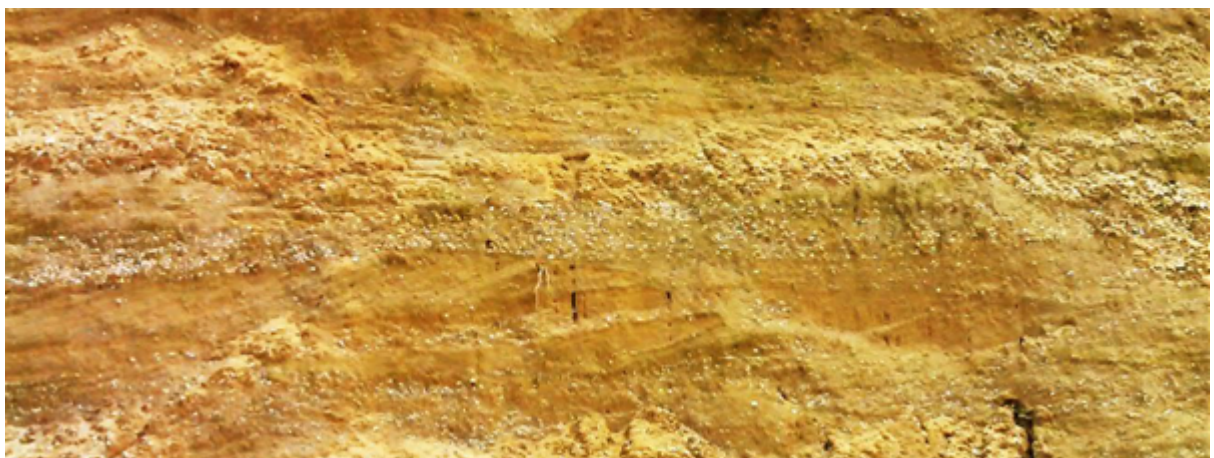
Figuur 2 Voorbeeld van heterogeniteit van zandafzettingen op decimeter tot meters schaal: rivierafzettingen (de foto beslaat een hoogte van ongeveer 3 m).
