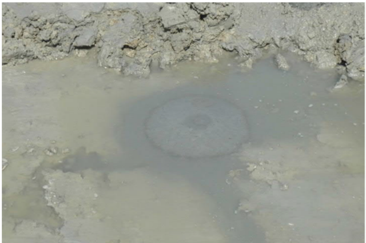
Figuur 3 Een wel (diameter van de conus 0,5 m) in een omgeving van getijdenafzettingen, ongeveer 8 m –NAP en 4 m beneden maaiveld en 1 m boven een getijdengeulafzetting.
