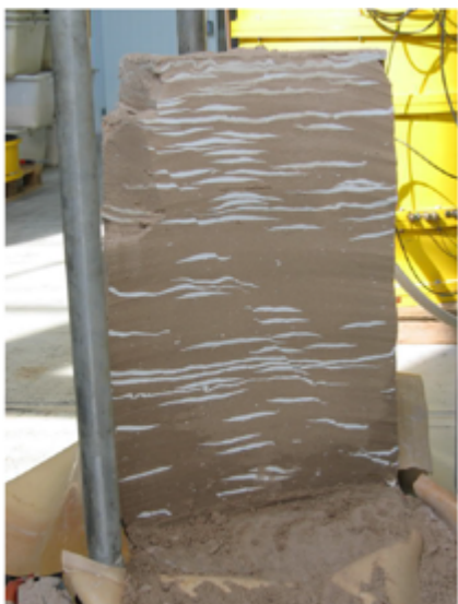
Figuur 2 Kunstmatig opgebouwd monsters met diameter 0.4 m. De flasers in het fijne zand zijn willekeurig georiënteerd en beslaan ongeveer 15 % van het oppervlak van de dwarse doorsnede. Het lutumgehalte van het gehele monster is 8 %, wat de grens is tussen zand en klei in de NEN 5104. De afzetting wordt vaak aangeduid als zand met kleilaagjes, of -brokjes of -insluitingen.
