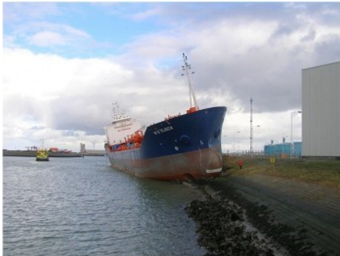
Figuur 1 Aanvaring van een schip met een dijk (bron onbekend.)
