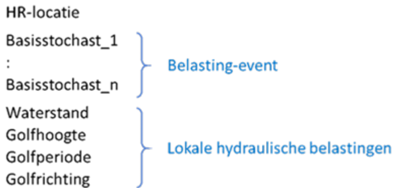
Figuur 1 De kolommen in de tabel met de fysische relatie tussen de basisstochasten en de lokale hydraulische belastingen parameters.
