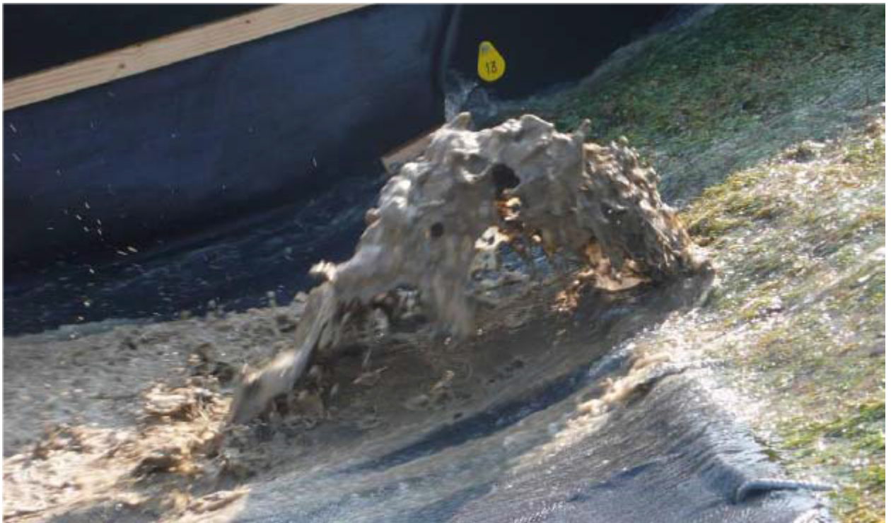
Figuur 6 Ondernijning van de kleilaag, Golfoverslagproef Tholen.
