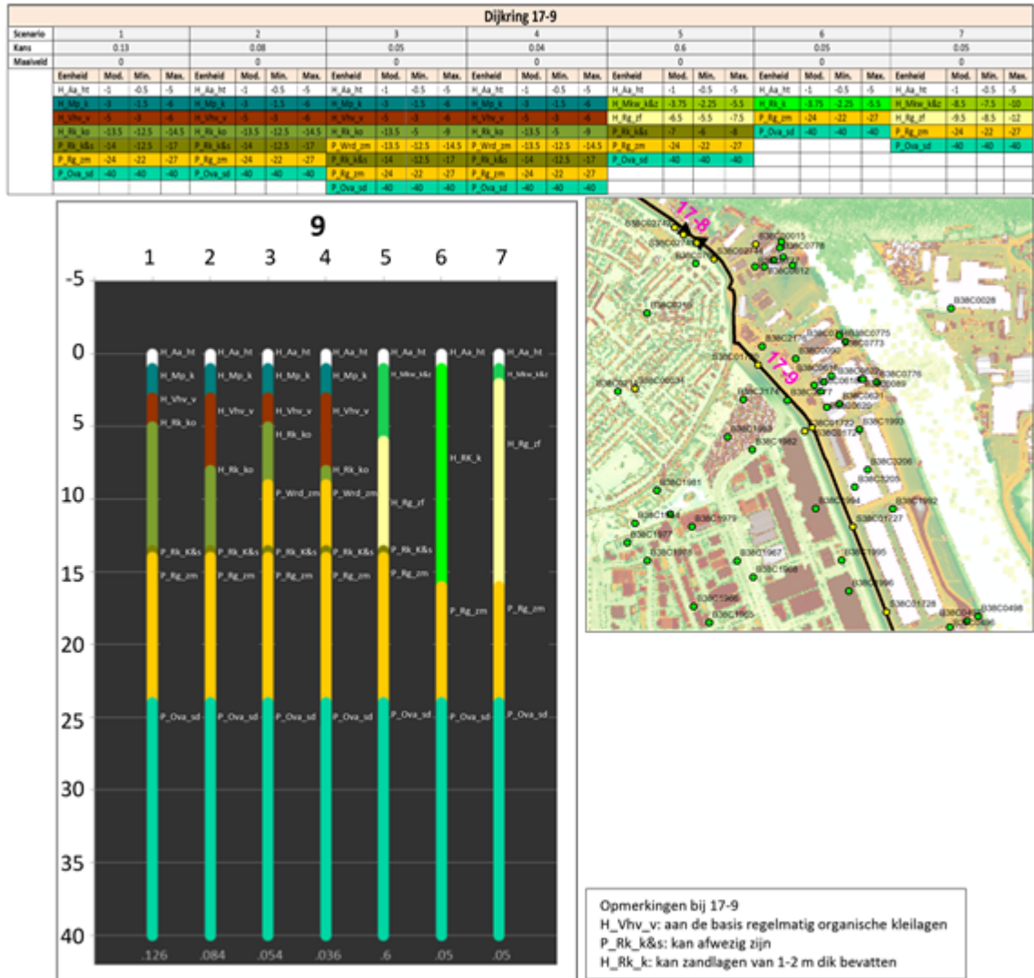
Figuur 1 Overzicht van de informatie die de SOS verschaft. In dit voorbeeld zijn zeven scenario's onderscheiden met een kans van aantreffen. Het bovenste tableau geeft per scenario van elk van de onderscheiden grondlagen de modale, minimum en maximum diepteligging weer. Het tableau linksonder is een weergave 'op schaal' van de grondlagen in de zeven scenario's, het tableau rechtsonder geeft een situatieschets met beschikbare grondonderzoekspunten
