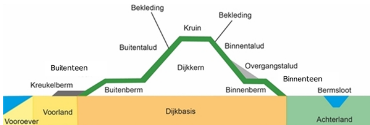
Figuur 1 Schematisatie van het dwarsprofiel.
