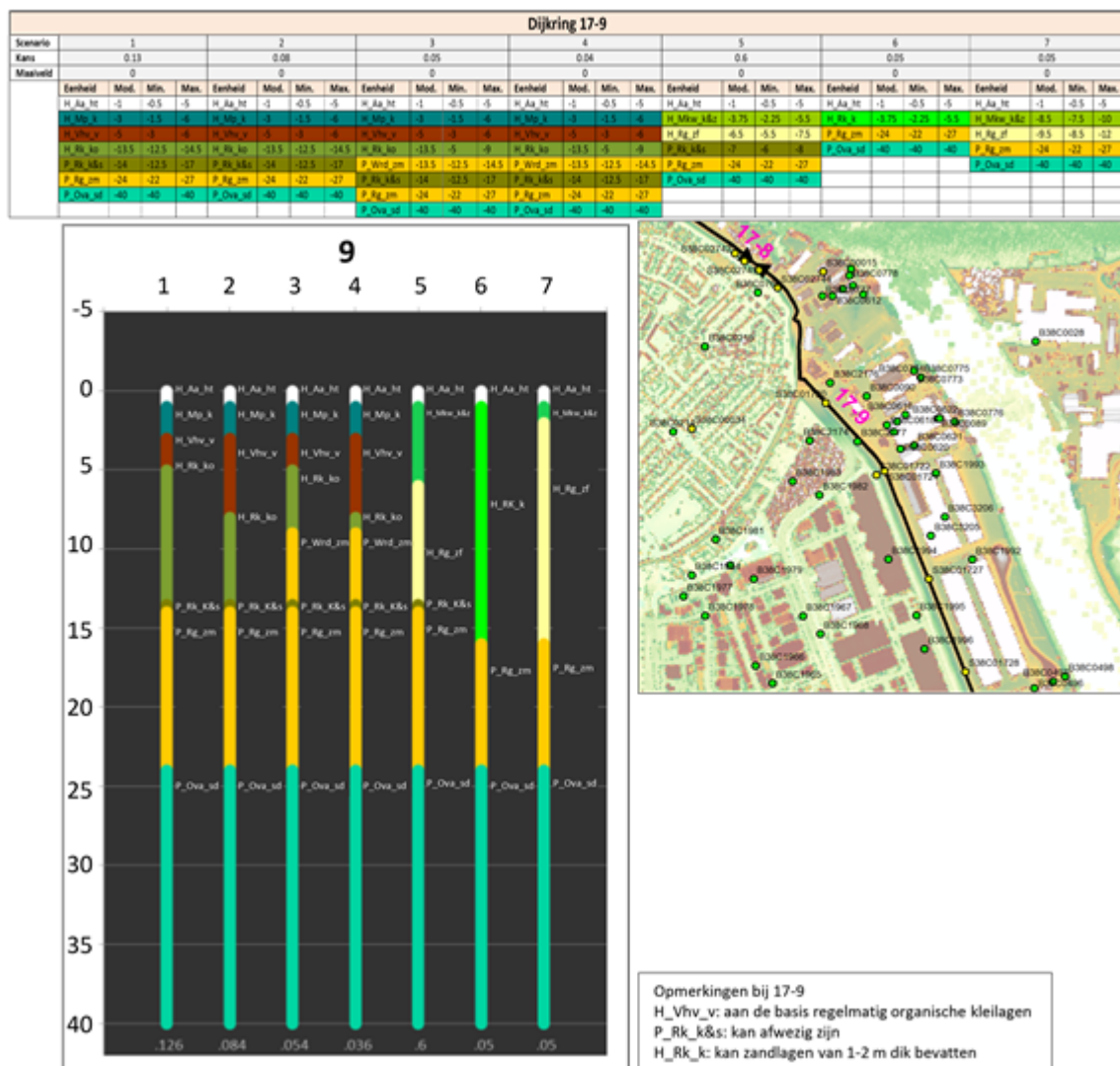
Figuur 1 Overzicht van de informatie die de SOS verschaft. In dit voorbeeld zijn zeven scenario's onderscheiden met een kans van aantreffen. Het bovenste tableau geeft per scenario van elk van de onderscheiden grondlagen de modale, minimum en maximum diepteligging weer. Het tableau
