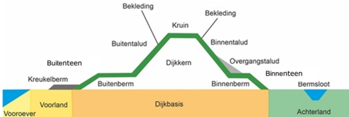
Figuur 1 Schematisatie van het dwarsprofiel.
