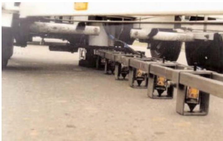
Figuur 2 Valgewicht-deflectiemeter: meetbalk met geofoons. (Foto NPC).
