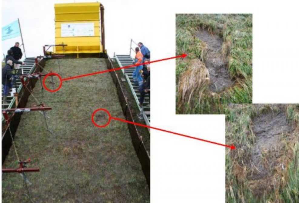
Figuur 1 Uittrekmechanisme. Golfoverslagproeven op Sint Philipsland.
