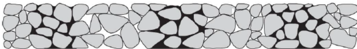
Figuur 2 Breuksteenbekleding patroonpenetratie.
