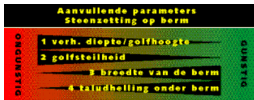
Figuur 1 Parameters steenzetting op berm.
