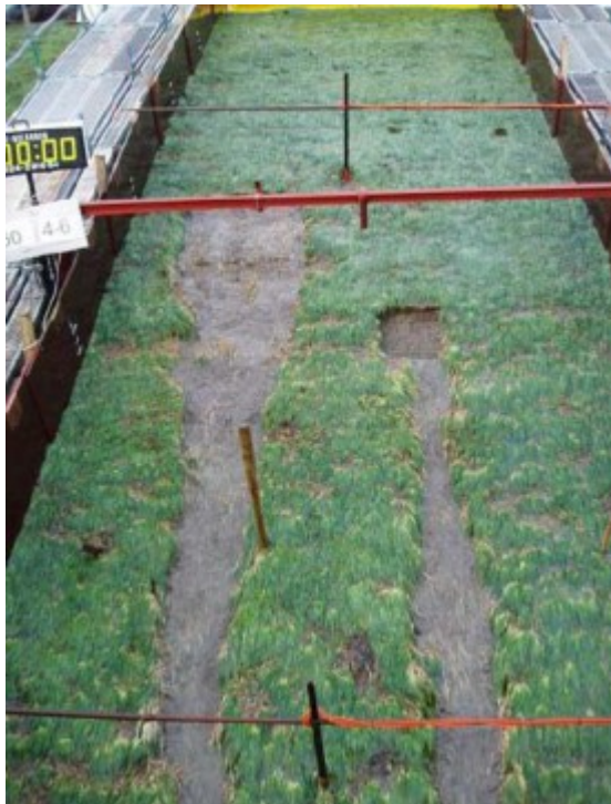
Figuur 1 Afstropen van een deel van de toplaag. Afsluitdijk.
