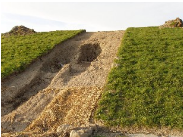
Figuur 1 Head cut erosie op een zeedijk van kale klei bij Delfzijl, beproefd met de golfoverslagsimulator na verwijderen van de top laag.
