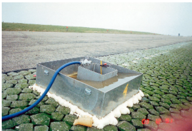
Figuur 1 Meting toplaagdoorlatendheid.
