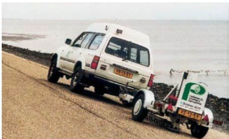
Figuur 1 Valgewicht-deflectiemeter op een dijktaalud. (Foto NPC).
