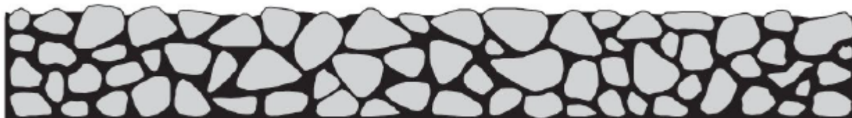
Figuur 1 Breuksteenbekleding penetratiemethode vol en zat.
