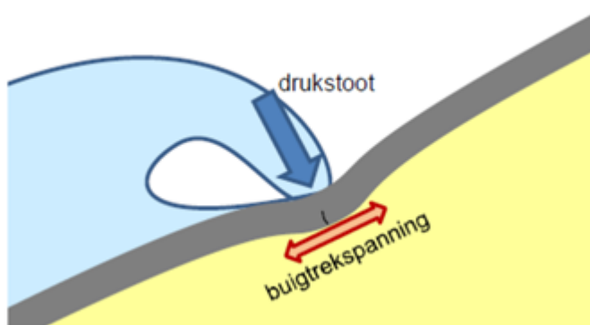
Figuur 1 Golfklappen op asfaltbekleding.
