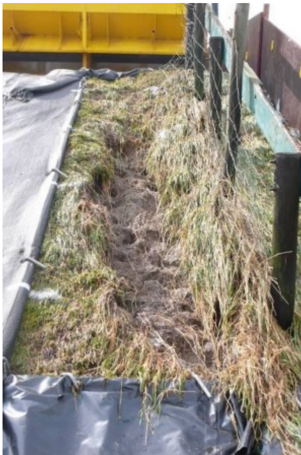
Figuur 1 Sponsachtige ophoging langs hekwerk. Golfoverslagproef op dijk bij Poortvliet op Tholen.
