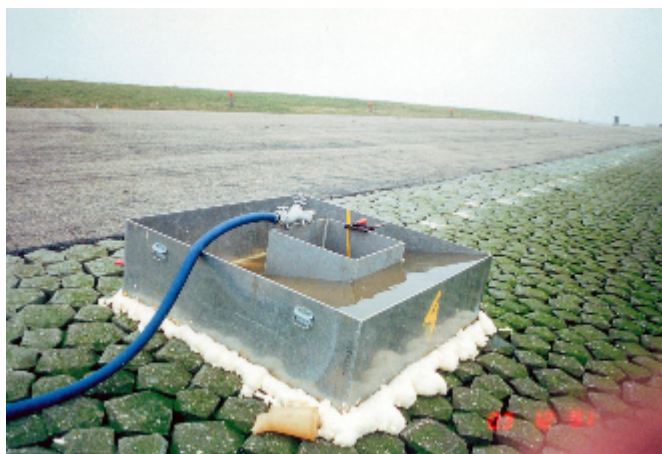
Figuur 1 Meting toplaagdoorlatendheid.
