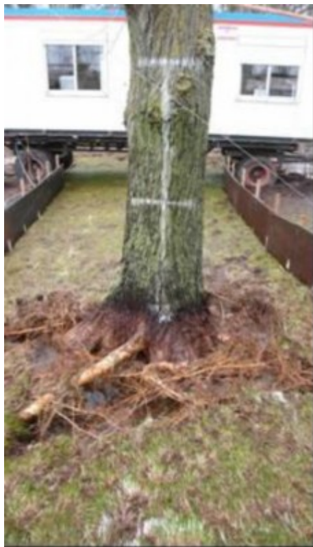
Figuur 1 Schade als gevolg van stroomconcentratie en turbulentie na grote overslagdebieten. Golfoverslagproeven Vechtdijk, 5 1/2 uur 50 l/s per m.
