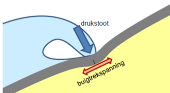
Figuur 1 Golfklappen op asfaltbekleding.
