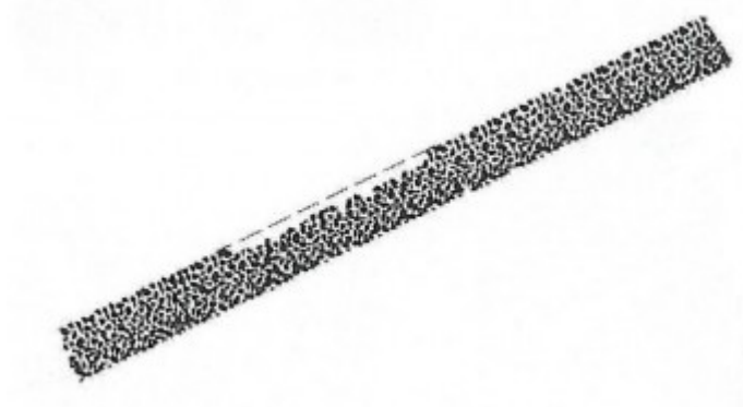
Figuur 5 Aangetast oppervlak: stenen uit het oppervlak verdwenen.
