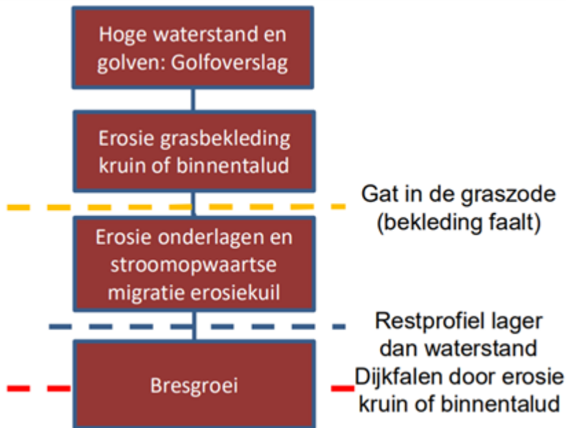
Figuur 2 Faalpad tot falen dijk als gevolg van erosie van de grasbekleding op de kruin en het binnentalud.
