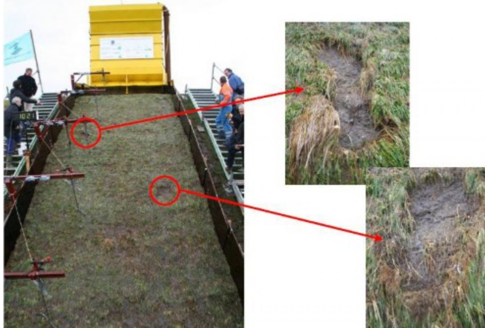
Figuur 1 Uittrekmechanisme. Golfverslagproeven op Sint Philipsland.
