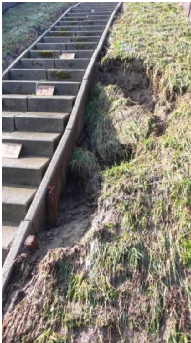
Figuur 3 Schade als gevolg van stroomconcentratie in combinatie met verminderde sterkte door onder andere het gebruik van onkruidwerend middel langs de trap. Golfverslagproef op dijk bij Poortvliet, Tholen, na 2 uur 5 l/s per m.
