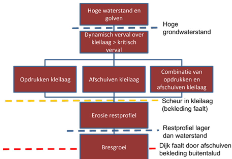
Figuur 9 Gebeurtenissen leidend tot falen van de dijk door afschuiven van de bekleding op het buitentalud.
