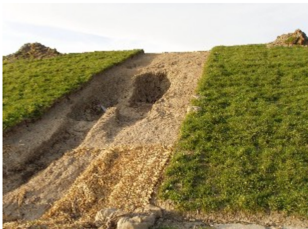
Figuur 1 Head cut erosie op een zeedijk van kale klei bij Delfzijl, beproefd met de golfoverslagsimulator na verwijderen van de topklaag.
