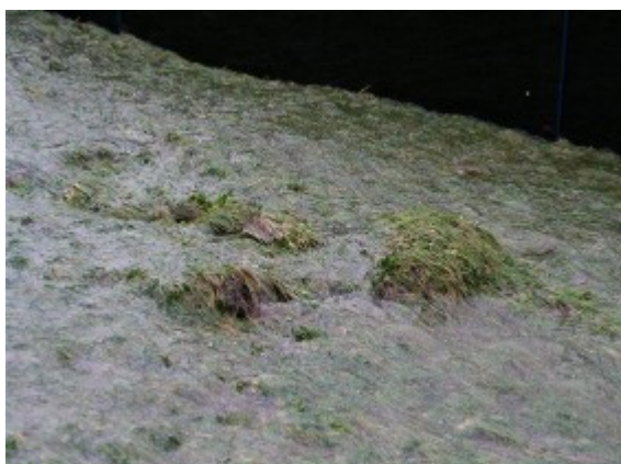
Figuur 2 Opbolmechanismen. Golfverslagproeven op Waddenzeedijk Friesland bij de Boonweg.
