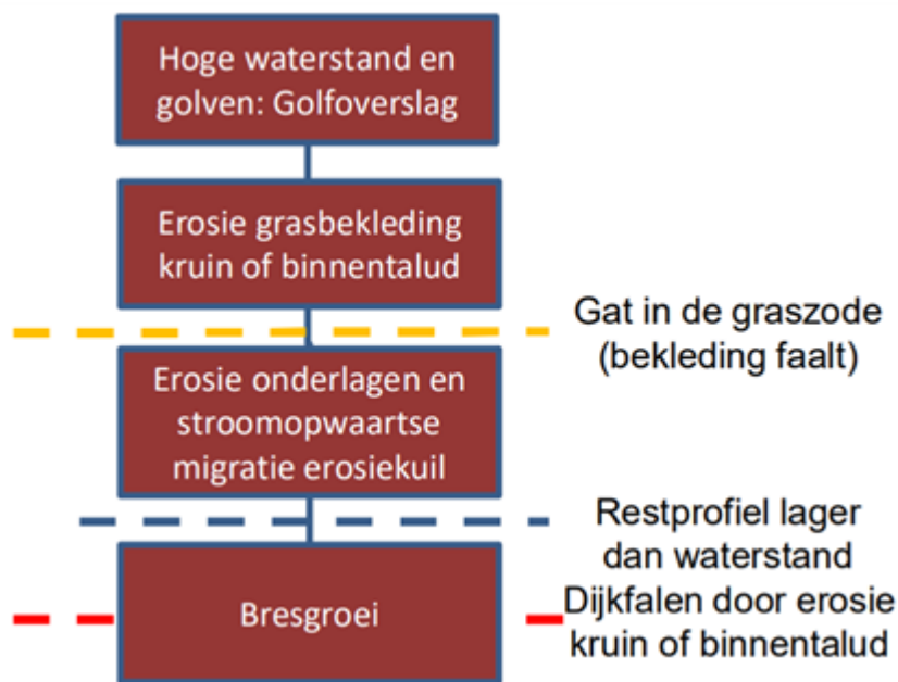
Figuur 2 Faalpad tot falen dijk als gevolg van erosie van de grasbekleding op de kruin en het binnentalud.
