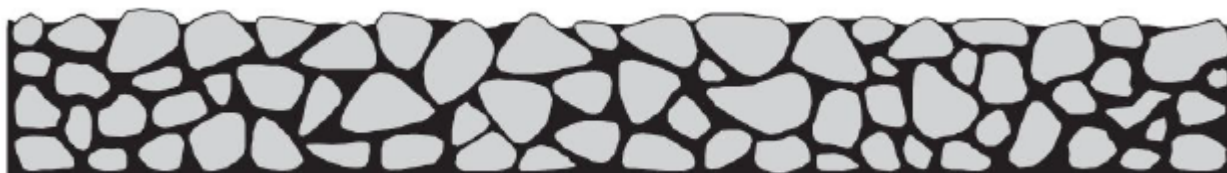
Figuur 1 Breuksteenbekleding penetratiemethode vol en zat.
