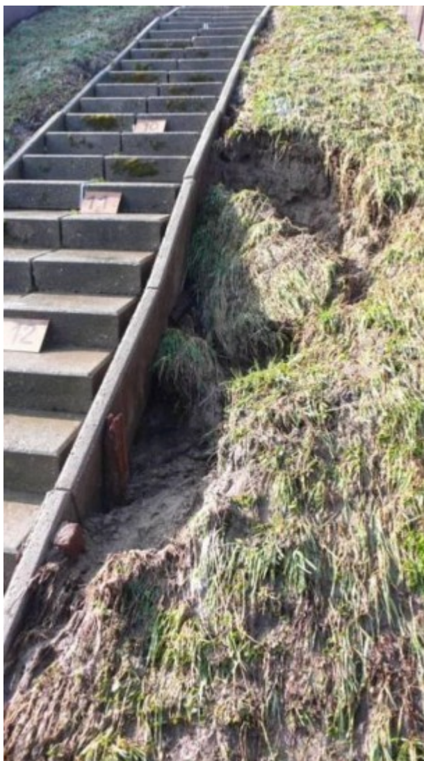
Figuur 3 Schade als gevolg van stroomconcentratie in combinatie met verminderde sterkte door onder andere het gebruik van onkruidwerend middel langs de trap. Golfoverslagproef op dijk bij Poortvliet, Tholen, na 2 uur 5 l/s per m.
