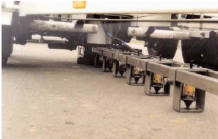
Figuur 2 Valgewicht-deflectiemeter: meetbalk met geofoons. (Foto NPC).
