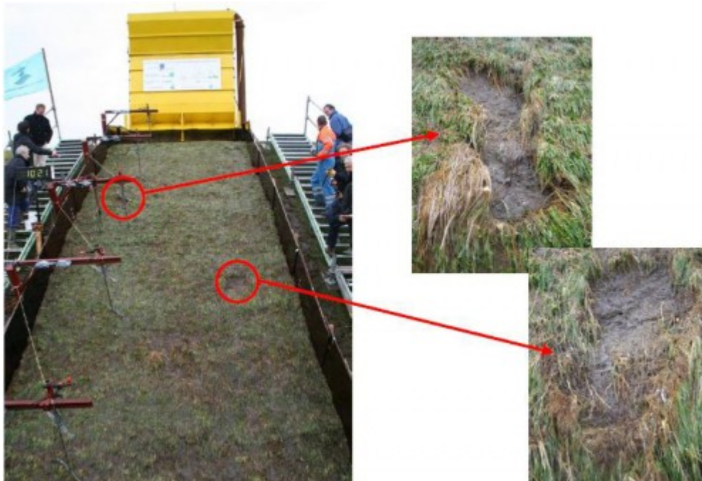
Figuur 1 Uittrekmechanisme. Golfoverslagproeven op Sint Philipsland.
