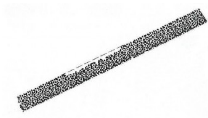
Figuur 5 Aangetast oppervlak: stenen uit het oppervlak verdwenen.
