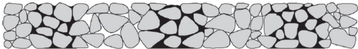
Figuur 2 Breuksteenbekleding patroonpenetratie.
