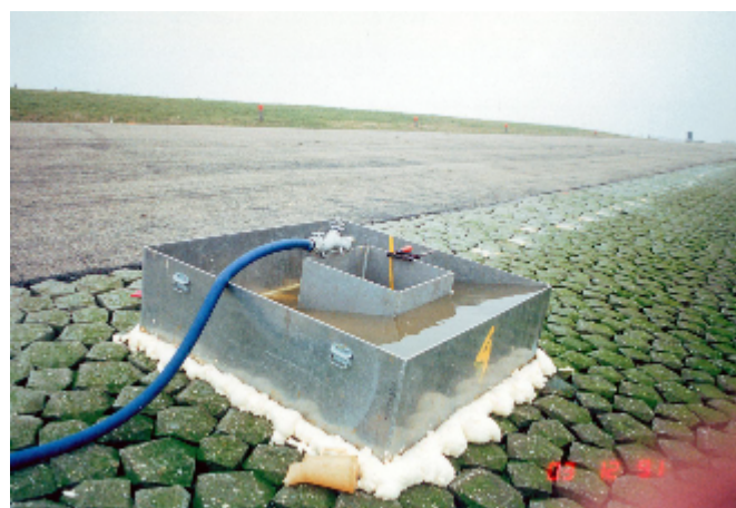
Figuur 1 Meting toplaagdoorlatendheid.
