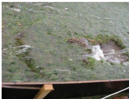
Figuur 2 Opbolmechanismen. Golfoverslagproeven op Waddenzeedijk Friesland bij de Boonweg.
