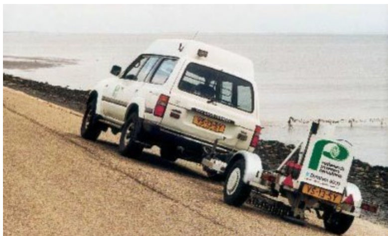
Figuur 1 Valgewicht-deflectiemeter op een dijktaud. (Foto NPC).
