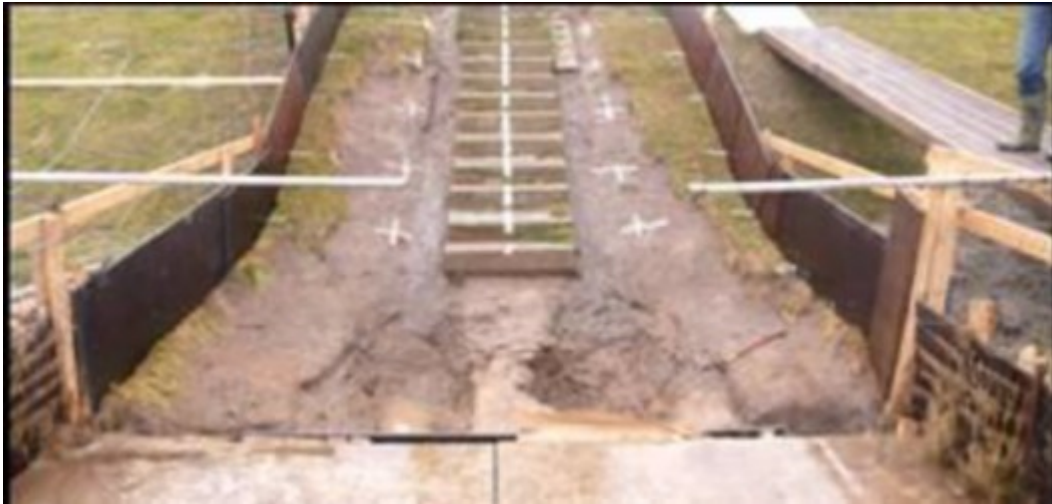
Figuur 2 Schade als gevolg van stroomconcentratie na zeer grote overslagdebieten. Golfoverslagproeven Afsluitdijk, 6 uur 50 l/s per m.
