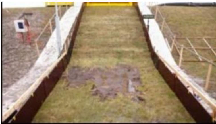
Figuur 1 Schade aan teen na 30 l/s per m. Golfoverslagproeven Friese Waddenzeedijk nabij de Boonweg.
