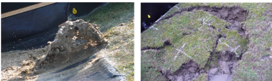
Figuur 6 Foto's van waarnemingen van het uitspoelen van zand tijdens golfoverslagproeven
