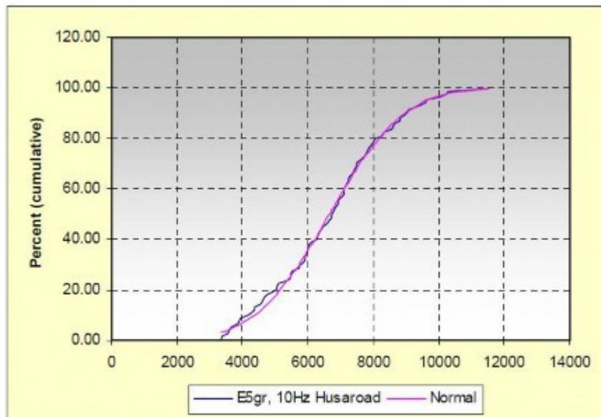
Figuur 1 Weergave van de gemeten elasticiteitsmoduli (bij 5°C en 10 Hz.) van een vak in een cumulatieve frequentieverdeling. De karakteristieke waarde (E95%) kan in de grafiek worden afgelezen.
