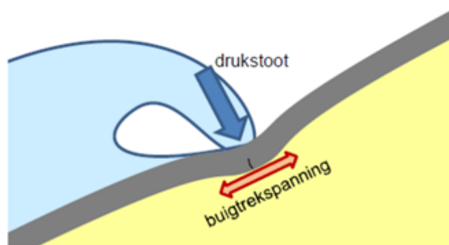
Figuur 1 Golfklappen op asfaltbekleding.
