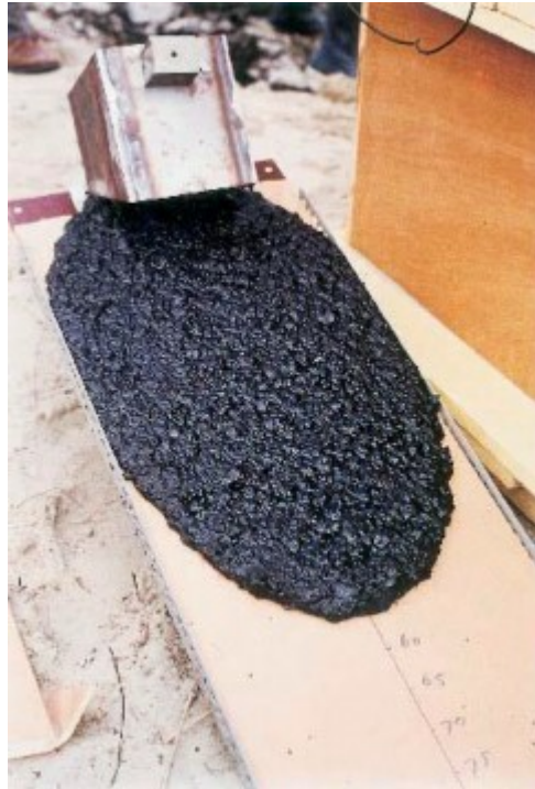
Figuur 2 Hellingproef voor het bepalen van de viscositeit.
