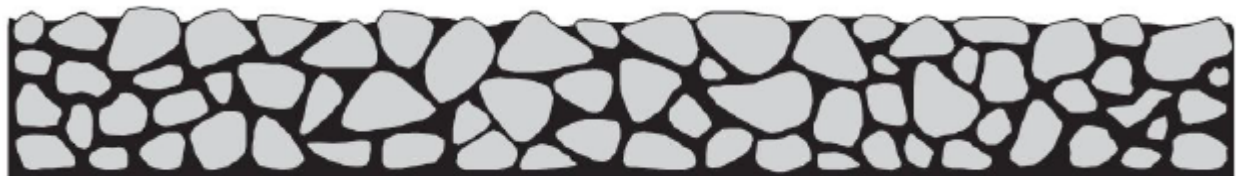
Figuur 1 Breuksteenbekleding penetratiemethode vol en zat.
