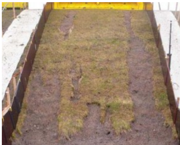
Figuur 1 Afstropen van een deel van de toplaag. Afsluitdijk.
