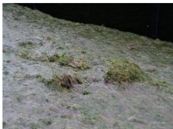
Figuur 3 Opbolmechanismen. Golfoverslagproeven op Waddenzeedijk Friesland bij de Boonweg.
