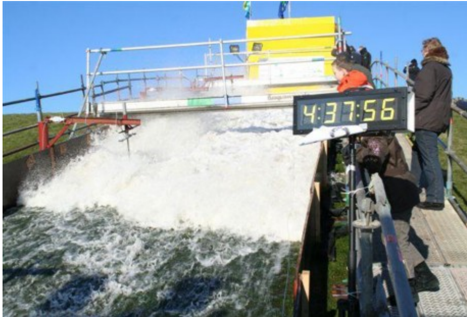
Figuur 2 De golfoverslagsimulator die een volume loslaat van 5,5 \text{ m}^3/\text{m} .
