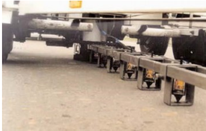
Figuur 2 Valgewicht-deflectiemeter: meetbalk met geofoons. (Foto NPC).
