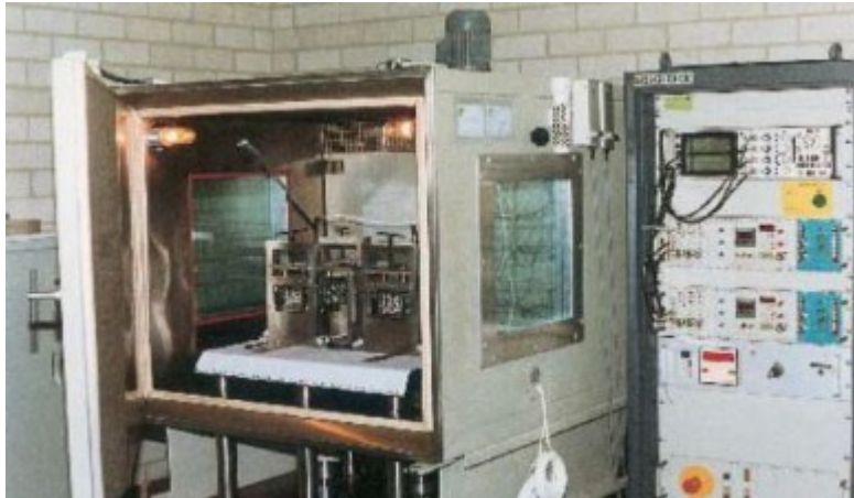
Figuur 2 Testbank met klimaatkast voor het uitvoeren van dynamische proeven. (Foto NPC).
