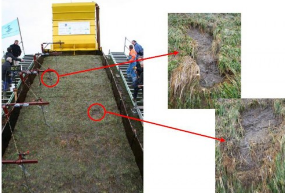
Figuur 1 Uittrekmechanisme. Golfverslagproeven op Sint Philipsland.
