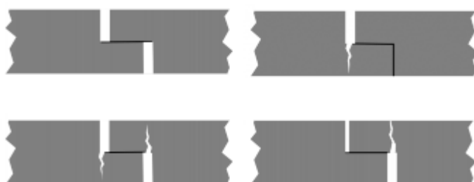
Figuur 3 Een aantal denkbare varianten van openstaande naden in geval van een liplas.
