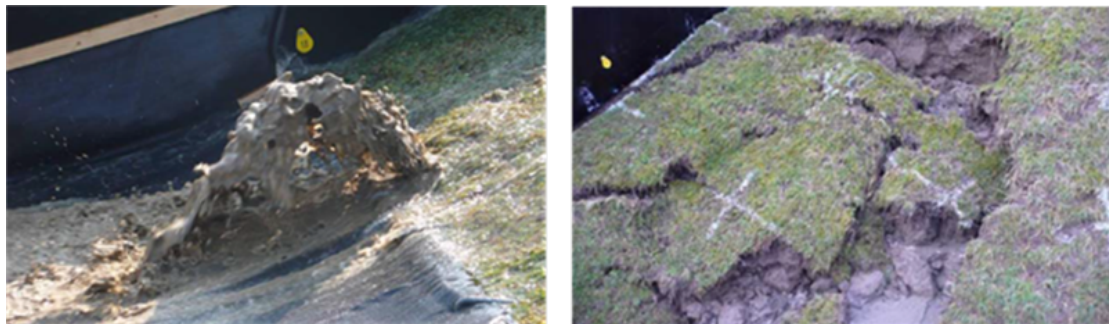
Figuur 6 Foto's van waarnemingen van het uitspoelen van zand tijdens golfoverslagproeven
