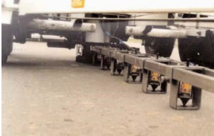
Figuur 2 Valgewicht-deflectiemeter: meetbalk met geofoons. (Foto NPC).
