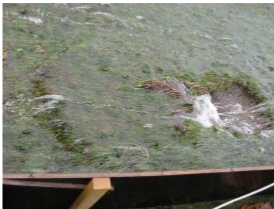
Figuur 2 Opbolmechanismen. Golfverslagproeven op Waddenzeedijk Friesland bij de Boonweg.
