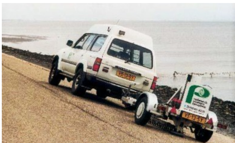
Figuur 1 Valgewicht-deflectiemeter op een dijktaald. (Foto NPC).
