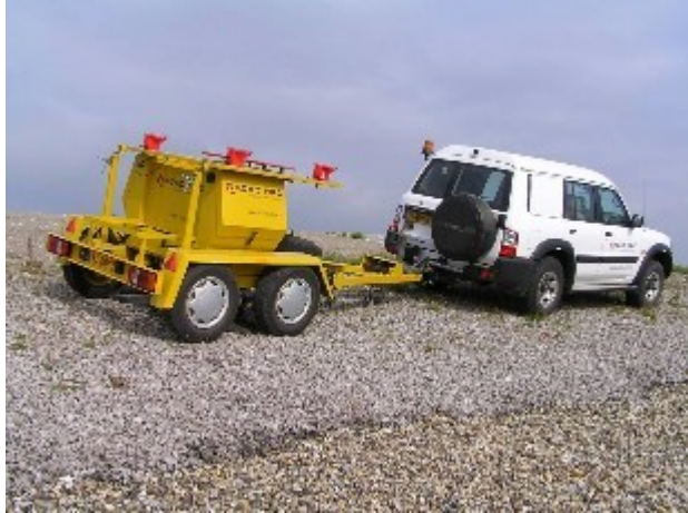
Figuur 3 Valgewicht-deflectiemeting op een talud op een bekleding van open steenasfalt.
