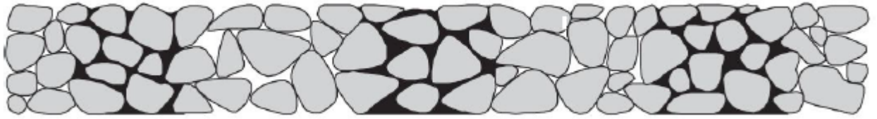
Figuur 2 Breuksteenbekleding patroonpenetratie.
