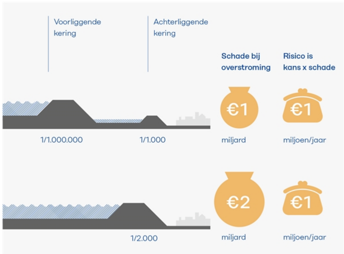
Figuur 1 Twee oplossingen, met en zonder voorliggende kering, die hetzelfde risico opleveren. Zonder voorliggende kering is de schade groter omdat er meer water binnenkomt.
